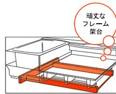
システムバスは、震度6強相当の振動にも負けない強度。浴室の重さを分散する「フレーム構造」の土台は耐久性抜群です。
